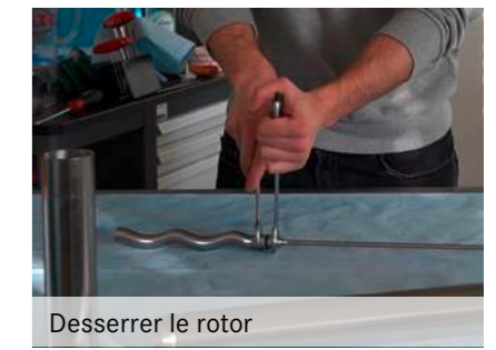
Fixer l'arbre, le dévisser et enlever la garniture mécanique
